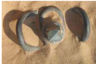
Nirotec beschichtete Spannklemme nach zwei Jahren Betriebserprobung in Wüstenregionen
